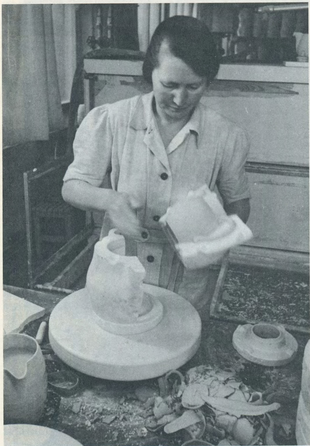
Gjutningen skedde i en delbar gipsform.
