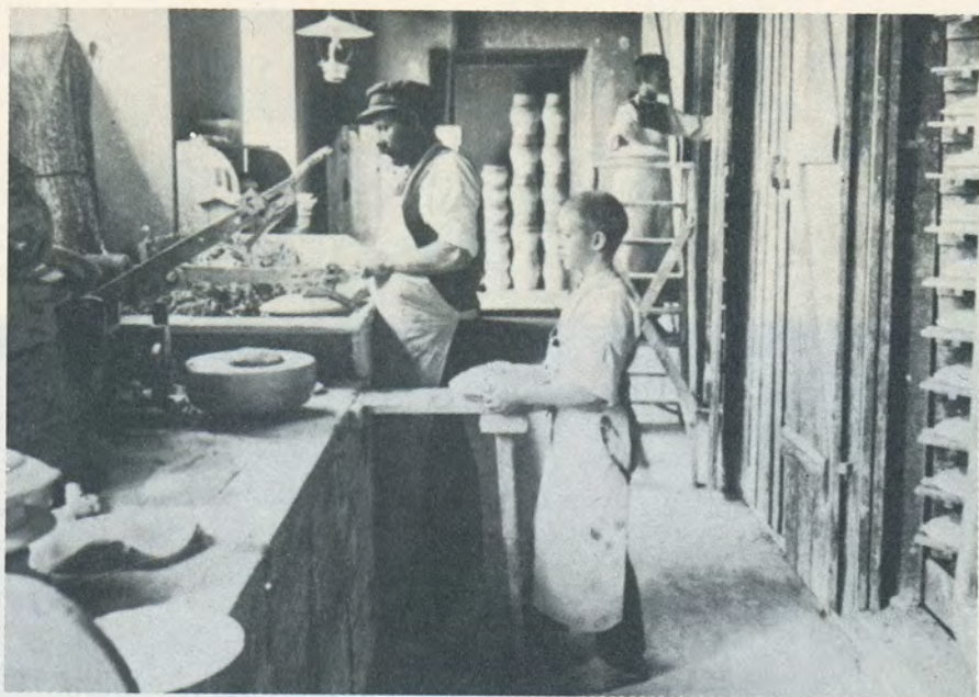
Tallriksformare med två "springpojkar" som langar tallrikar, 1895. Th syns ett torkskåp.
